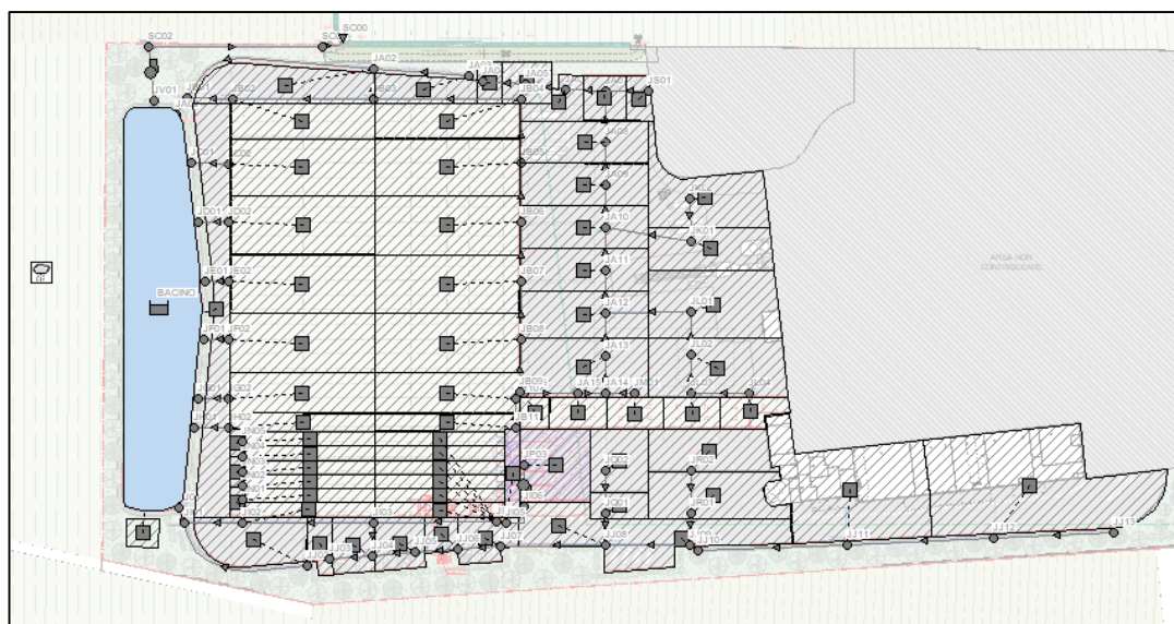
Figura 4.4.1 – Schematizzazione della rete SWMM
